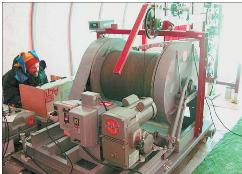
Геофизические наблюдения проводились с помощью лебедки, установленной на поверхности в специальной палатке.
